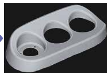
把面拼接后，完成三维 CAD模型
